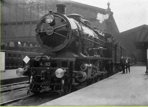
Locomotive type 140 construite par CAIL au début du XXe S
