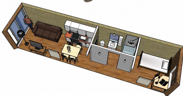
Aménagement d'un conteneur en logement étudiant
