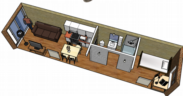
Aménagement d'un conteneur en logement étudiant
